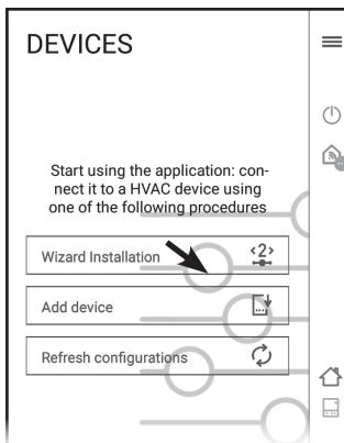
**POZNÁMKA:** označenie zariadenia „HVAC“ (skratka z Heating -Ventilácia – klimatizácia) sa v tomto prípade vzťahuje na WIFI modem keďže APP komunikuje so systémom cez WIFI modem.
