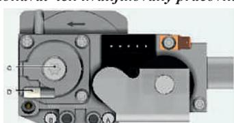
Pri maximálnom výkone sa CO<sub>2</sub> nastavuje regulačnou skrutkou D, pri minimálnom výkone sa CO<sub>2</sub> nastavuje regulačnou skrutkou C.
