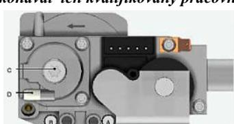
Pri maximálnom výkone sa CO2 nastavuje regulačnou skrutkou D, pri minimálnom výkone sa CO2 nastavuje regulačnou skrutkou C.
