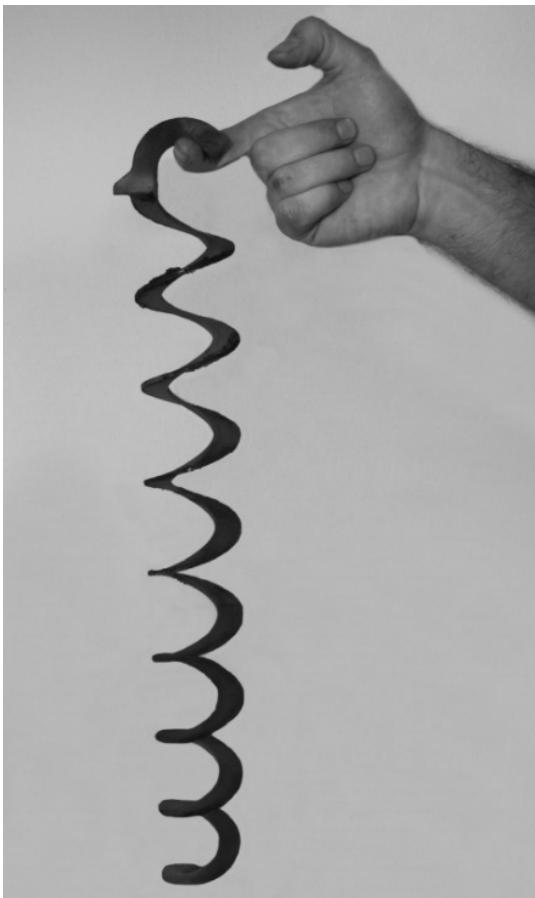
Ak bol kotol z nejakého dôvodu prevádzkovaný nesprávnym spôsobom, je možné že došlo k zaneseniu turbulátorov a tým k zníženiu priechodnosti spalín. Ak sa tak stane, Turbulátory je nutné z kotla demontovať a vycistiť priestor medzi jednotlivými závitmi napríklad drôtenou kefou. Turbulátory je nutné vrátiť naspäť do rúr aby sa neznížila účinnosť kotla. (Neplatí pre model 15DPX)
