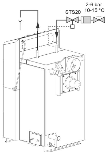
*Ak pri otvorení termostatického ventilu STS20 nebude zabezpečený obeh chladiacej vody cez dochladzovací okruh hrozí nebezpečenstvo poškodenia kotla! V takomto prípade sa záruka na kotel nevzťahuje.*
